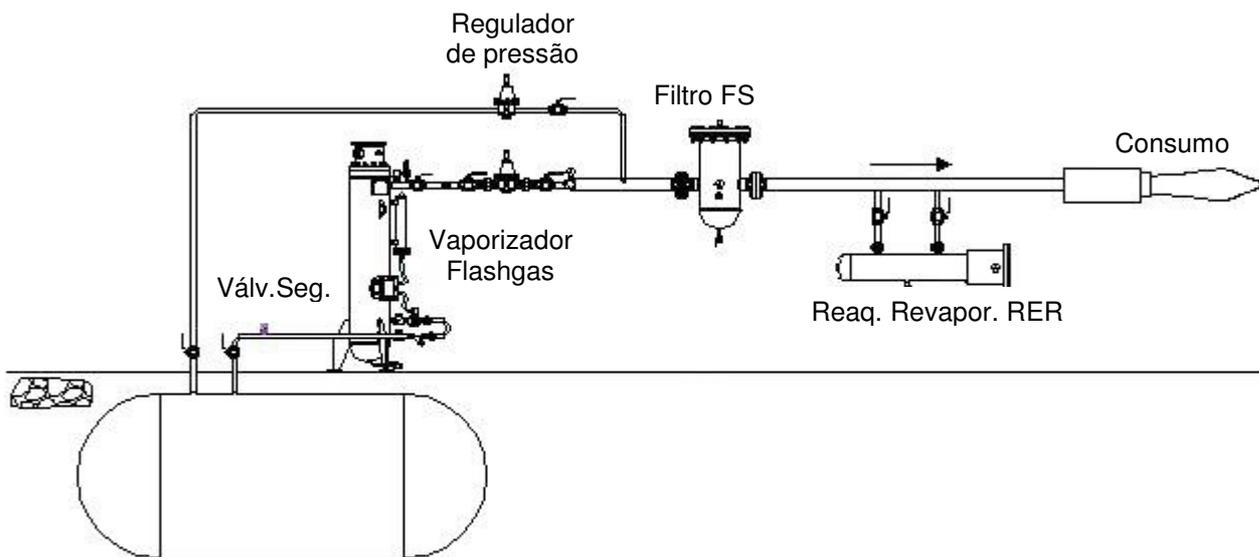
COM TANQUE AÉREO E REAQUECEDOR E REVAPORIZADOR
