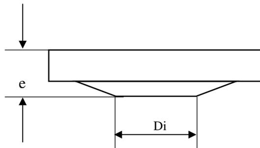
$e_a$  = espessura do flange adotada = 50,8mm
